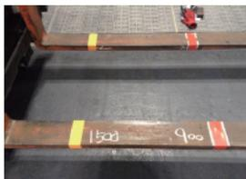
フォークのツメに写真のように、先端から距離を記入することで、ツメ先端が荷物で隠られても、距離が目印となり、壁の追突など避けることができる。
