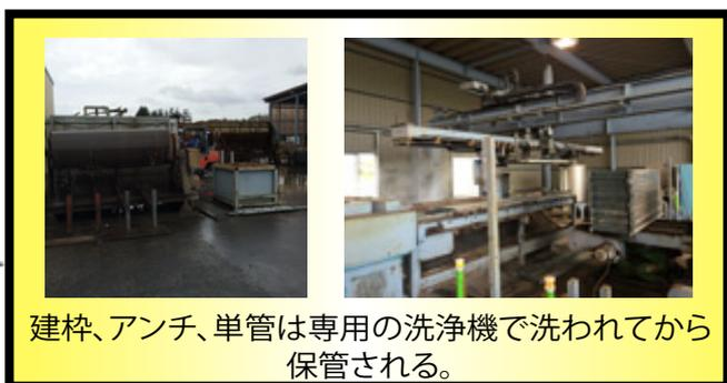
建枠、アンチ、単管は専用の洗浄機で洗われてから保管される。
